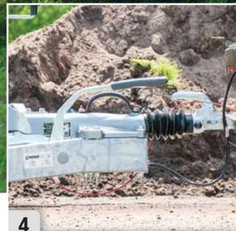
4 Geschroefde dissel met 2 koppelhoogte mogelijkheden
