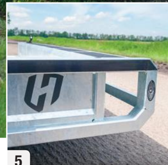
5 Robuste voorkant met ingebouwde breedteverlichting
