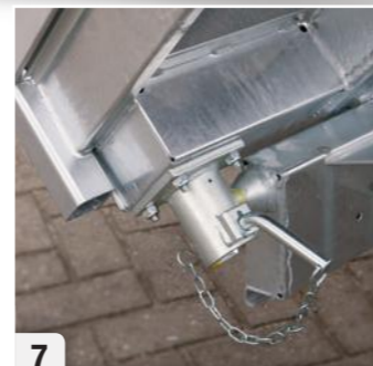
7 Zowel achterwaarts als zijwaarts kippend mogelijk Système de basculement simple ou système tri-benn
