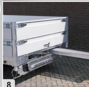
8 Slede gelast in chassis (t.b.v. rijplaten), Leverbaar met aluminium (of stalen) rijplaten (optie) Chassis surbaissé avec rangement de rampes (en alu ou acier) (option)
