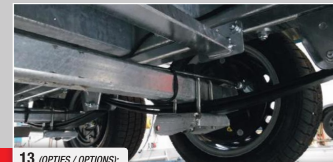
13 (OPTIES / OPTIONS): De Parabolische veren met standaard schokbrekers. Ressort à lame (Parabolic) avec amortisseurs standard
