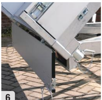
6 Bij hoogste kipstand komt het achterbord niet aan de grond en beschermd het tevens de achterlichten Ridelle arrière: en position inclinée toujours suffisamment de distance au sol, en constituant en même temps une protection efficace des feux arrière
