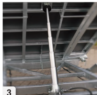
3 5-traps, zeer sterke cilinder, met 48° kiphoek (geschikt tot 6100 kg) Vérin très puissant (5 cylindres) inclinaison 48° (force de traction 6100 kg)
