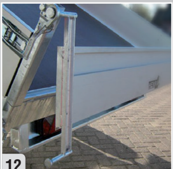
5-stufiger, sehr starker Zylinder, Kippwinkel 48° (bis 6100 kg)
